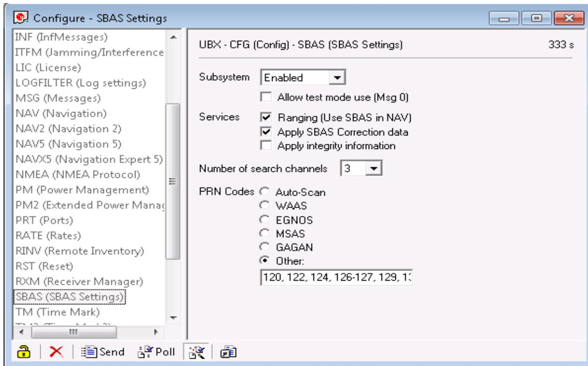
Im NL-6022MP ist standardmäßig der Empfang von EGNOS eingeschaltet. Im Konfigurationsmodus können Sie diese Einstellungen kontrollieren. Genauere Infos hierzu entnehmen Sie bitte der aktuellen Dokumentation unter <http://www.u-blox.com>.
