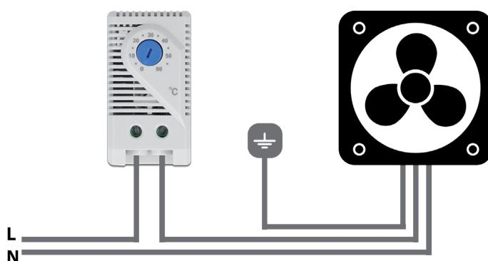
În mod normal, contactul deschis (contactul de comutare se închide când crește temperatura)
