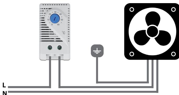
Contact normalement ouvert (le contact de commutation se ferme quand la température augmente)
