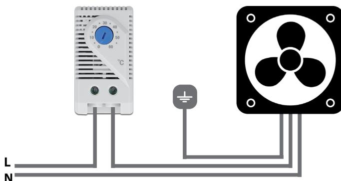
Contacto normalmente abierto (el contacto de conmutación se cierra cuando aumenta la temperatura)
