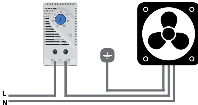
Uobičajeno otvoreni kontakt (kontakt prespajanja zatvara se kod povećanja temperature)
