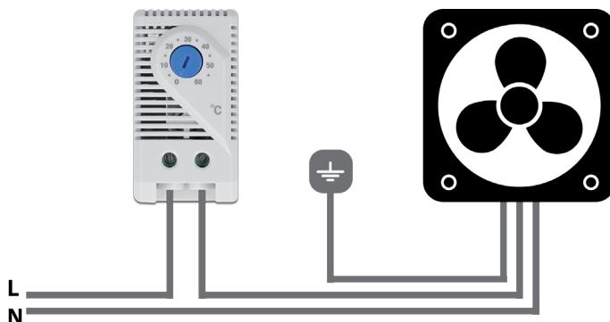
Öffner (Schaltkontakt bei steigender Temperatur schließend)
